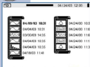
Ud. puede almacenar hasta 12 fotos instantáneas de la pantalla simplemente pulsando el botón cámara mientras la información deseada de cualquiera de los modos del instrumento se encuentra en pantalla. Cualquiera de las instantáneas almacenadas puede ser escogida y presentada seleccionándola de la lista.
