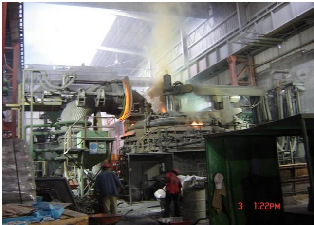
Fig. 6 Horno de arco eléctrico.
