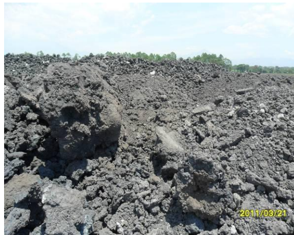
Fig. 1 Depósito de escoria de horno fusión.
