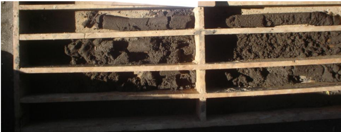
Fotografía 11: testificación geotécnica del suelo Sondeo 2 (Laboratorio Grupo PHI, S.A.)
