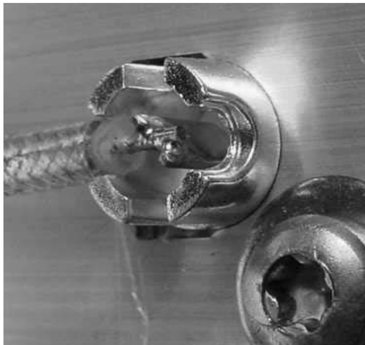
Figura 66. Conexión de cable sin soldar de una antena defectuosa
