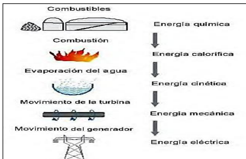
Figura 6. Proceso de la generación de energía en un ingenio azucarero
