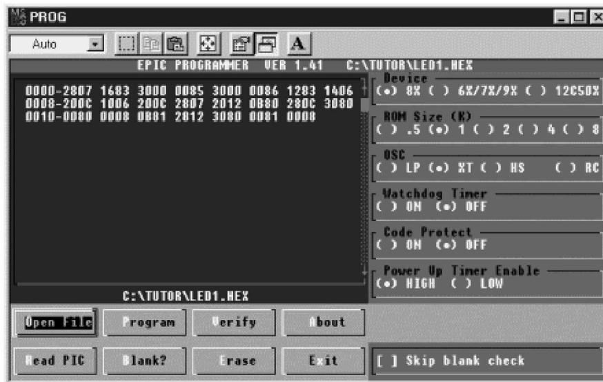
Ya colocado debidamente el PIC en el grabador, se selecciona la opción **Program** y se espera a que te aparezca el mensaje **Programming Complete**
