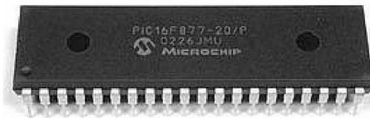
El encapsulado más común para estos microcontrolador es el DIP (Dual In line Pin) de 40 pines y utiliza un reloj de con una frecuencia minima de 4 MHz (cristal de cuarzo) hasta los 20 MHz Sin embargo, hay otros tipos de encapsulado, por ejemplo, el encapsulado tipo surface mount (montaje superficial) es mucho más pequeño.
