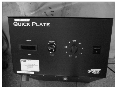
Figura 86. Selector de amperaje para el proceso de metalizado
