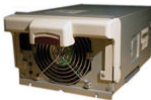
Figura 17. Fuente de poder con capacidad de cambiarse en caliente
