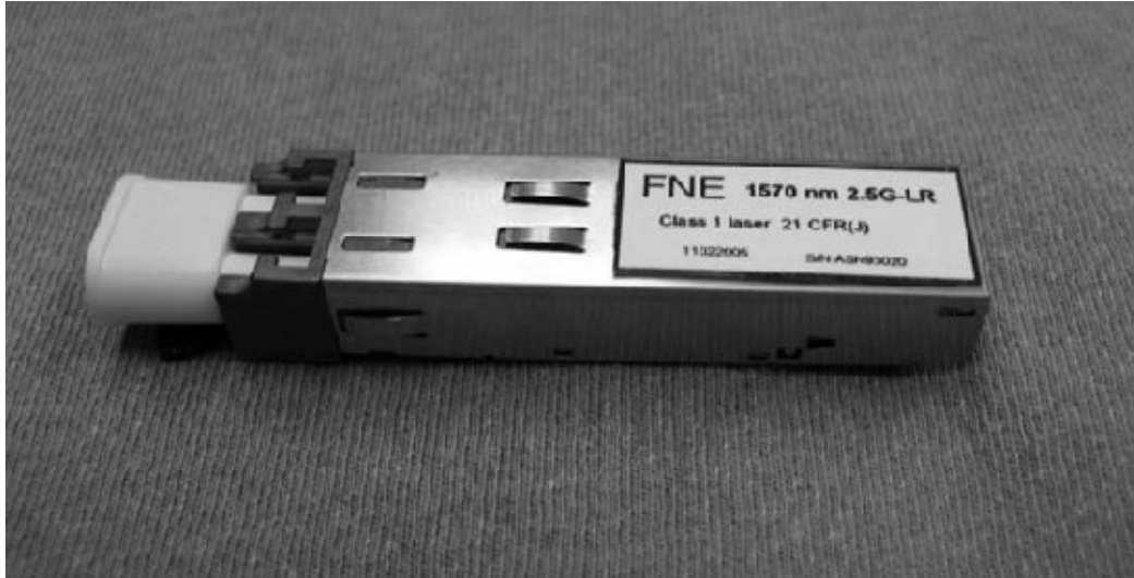
Figura 49 Transciever SFP para longitud de onda de 1570nm CWDM.
