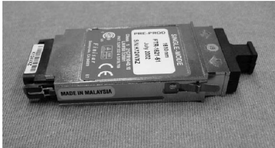
Figura 48 Un transciever GBIC para longitud de onda CWDM de 1610nm
