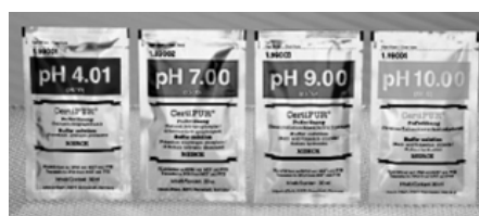
Figura 64. Buffers de pH utilizados para las mediciones realizadas.
