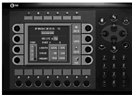
Figura 46 Pantalla de interfase remota con el operador
