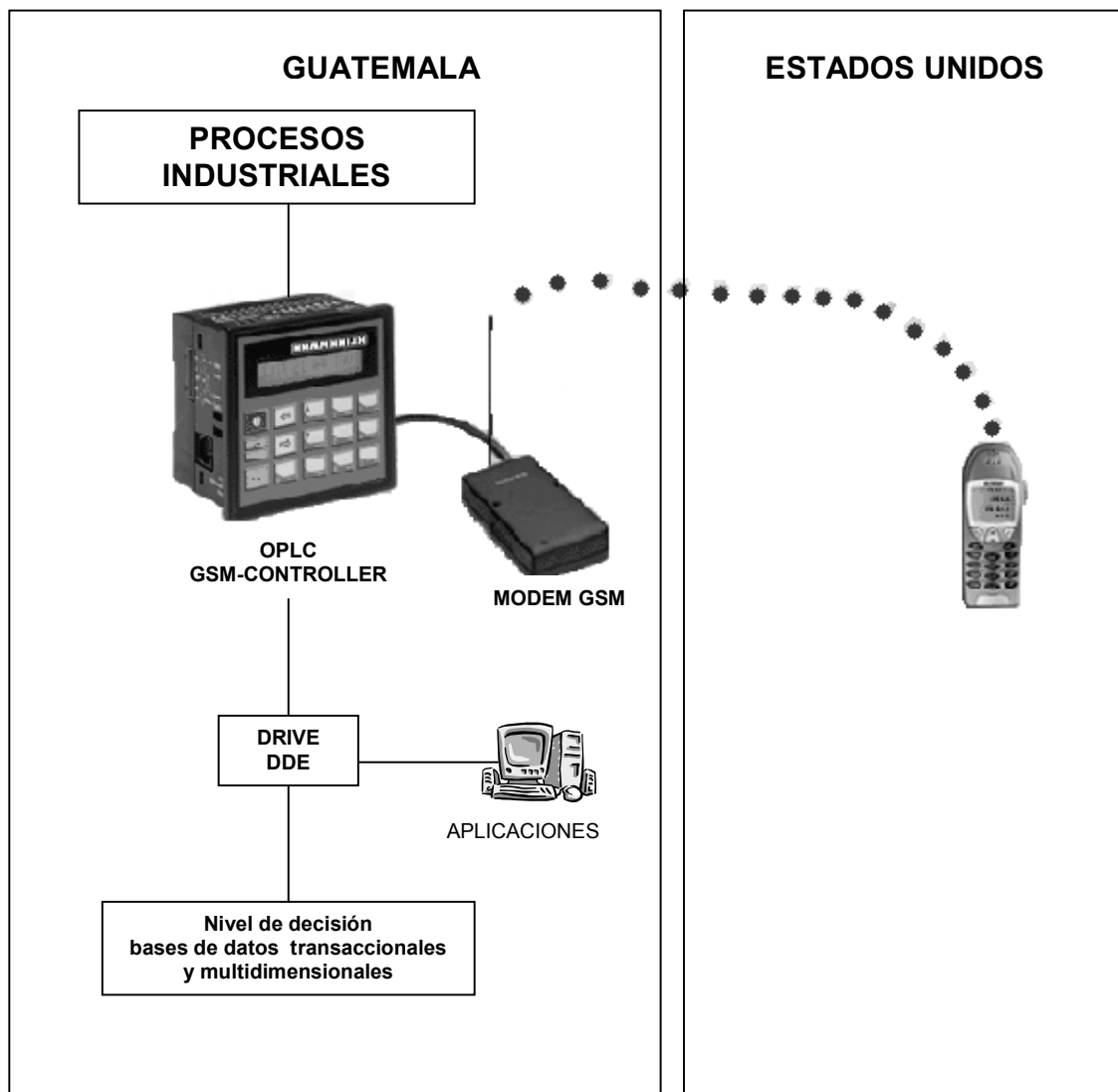
Figura 23 El modelo de automatización utilizando cobertura celular GSM
