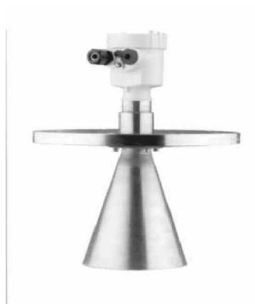
**4.1.1 Modulo electrónico.** Es el encargado de generar los pulsos electromagnéticos y transmitir la información electrónica, así como la alimentación eléctrica. También llamada cabeza electrónica.
