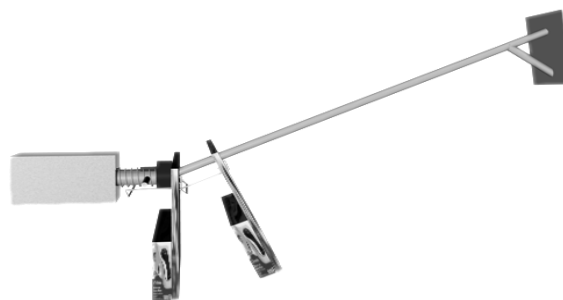
Figura 31. Varilla de metal con soporte para ayudar a la estabilidad.
