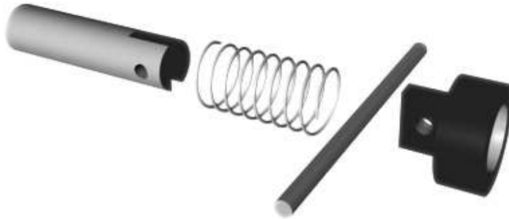
Figura 23. Selenoide, resorte, pin y cabeza de hule.
