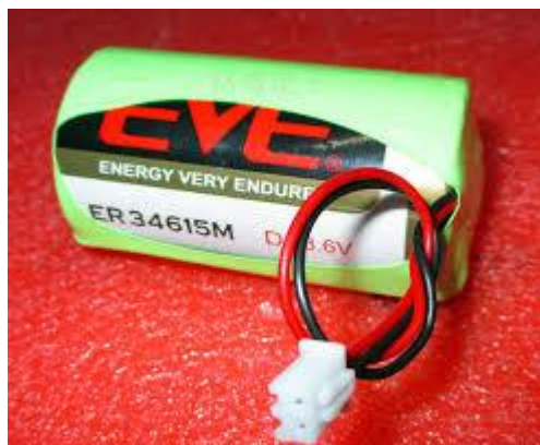
Figura 7. Batería de litio de medidor electrónico de energía eléctrica
