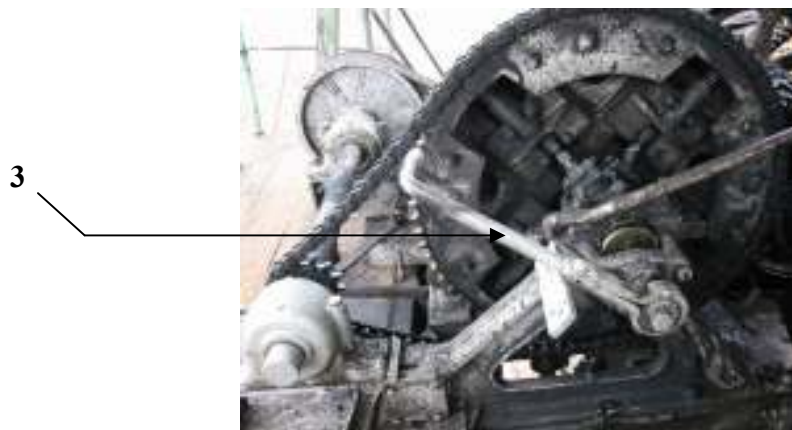
Figura 9. Mecanismo de accionamiento de movimiento vertical
