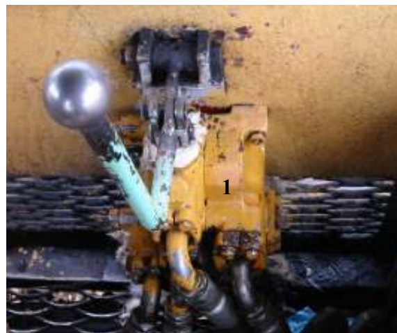
Figura 10. Palanca de mando oleohidráulico del cilindro principal
