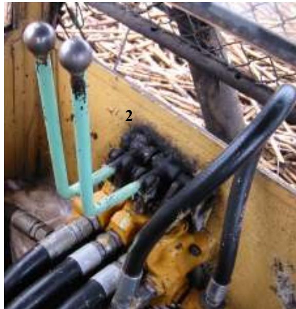
Figura 11. Palancas de mandos oleohidráulicos cilindros auxiliares
