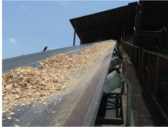
Figura 1. Alimentación de ingenio azucarero con chip de eucalipto
