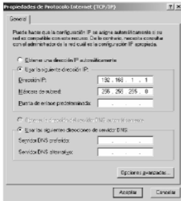
Ahora se procederá a confirmar que las conexiones se encuentren debidamente configuradas y que la computadora pueda salir a Internet por medio del otro a través de Bluetooth. Primero se tiene que verificar que exista comunicación entre los dos dispositivos, esto se realiza por medio del comando ping, el cual comprueba que otro dispositivo que cuente con cierta dirección IP esté activo dentro de la red.
