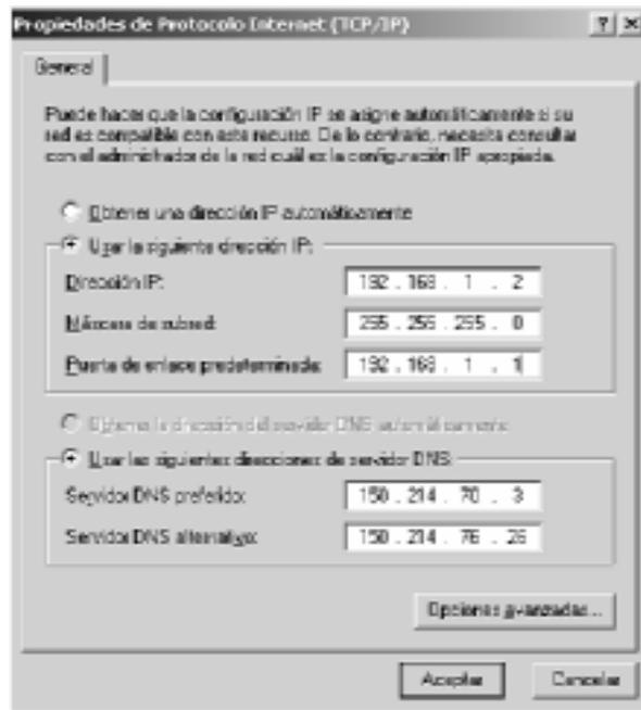
A continuación se efectuará el mismo proceso con la computadora que tiene la conexión a Internet, ingresando primero a las propiedades de la conexión Bluetooth y asignándole la siguiente configuración de red:
