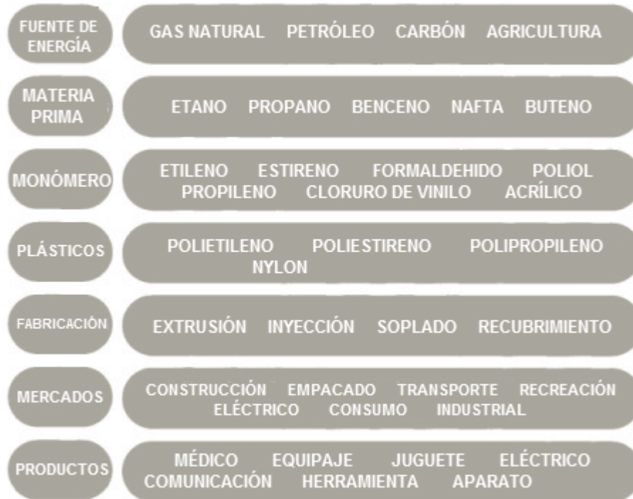
Figura 10. Proceso de elaboración de productos de plástico
