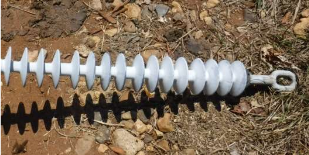
Figura 34. Discontinuidades por detectar en aislamiento de Polímero
