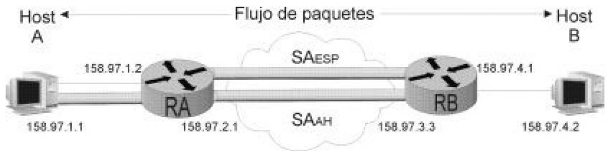
Figura 45. Método de trabajo de IPSec en IPV6, túneles anidados
