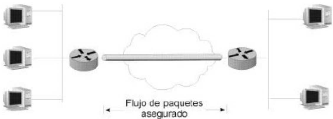
Figura 43. Método de trabajo de IPSec en IPV6, redes privadas virtuales
