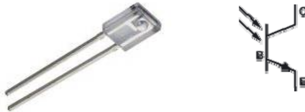
Figura 43 Fotografía y símbolo de un fototransistor.
