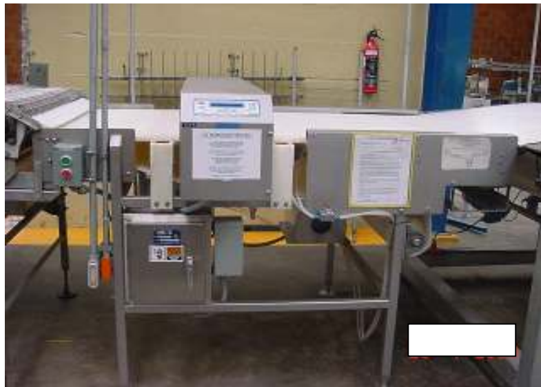
Figura 10. Detector de metales instalado en la línea de producción.
