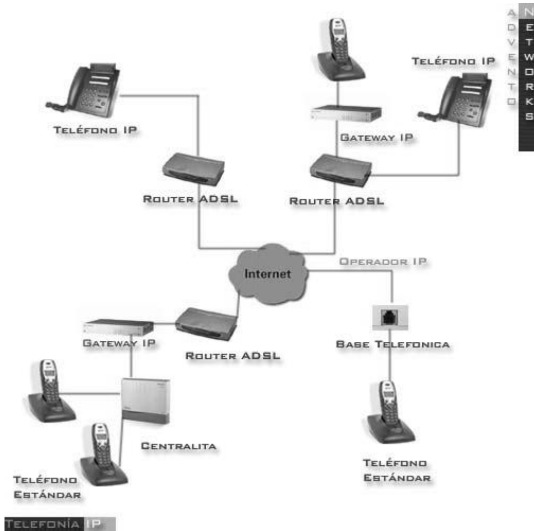
Figura 13. Arquitectura general de telefonía IP
