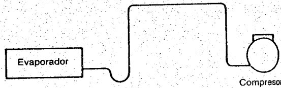
Figura 31. Tubería de succión (el evaporador y el compresor situados al mismo nivel)
