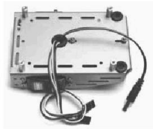
Figura 71. (a) Porta-pilas ensamblado. (b) Cables de los servos y del porta-pilas.
