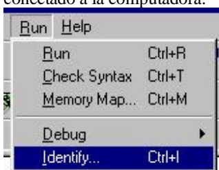
Figura 61. Detectando el microcontrolador que está conectado a la computadora.
