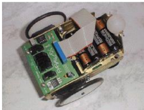
Figura 76. Módulo seguidor de líneas ensamblado al chasis de Samy-Bot .
