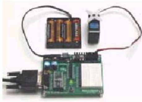
Figura 64. Servo y porta-pilas conectados a la plaqueta de educación.
