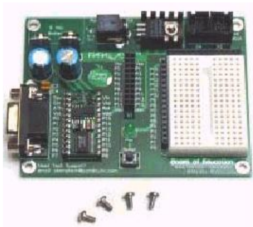
Figura 72. Componentes necesarios para colocar el sistema de control a Samy-Bot .
