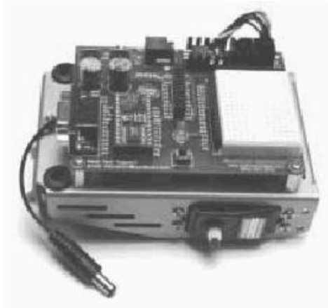
Figura 73. Sistema de Control montado al chasis de Samy-Bot .
