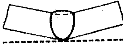
Figura 119. Deformación de una soldadura a tope resultante de la dilatación y contracción térmicas no controladas
