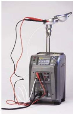
Figura 42. Calibrado pozo seco
