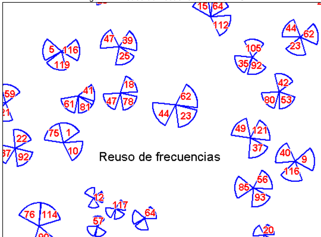
Figura 17. Reuso de frecuencias en las BTS
