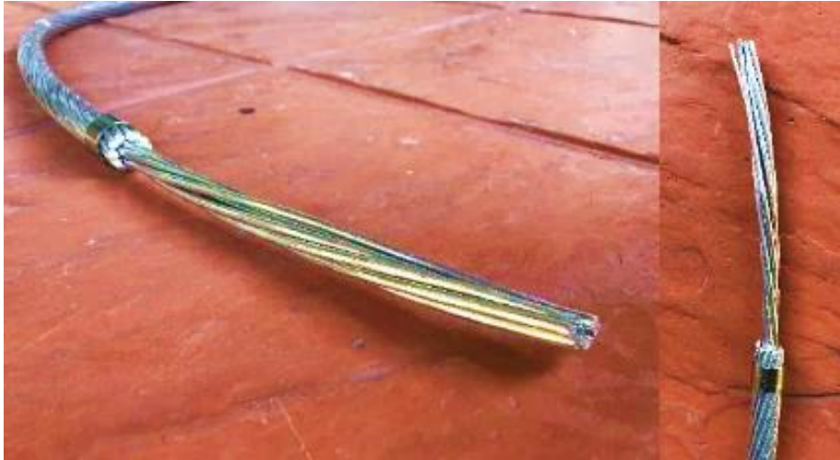
Figura 24. Cable de aluminio sin forro 559,5 AWG AAAC (darien)
