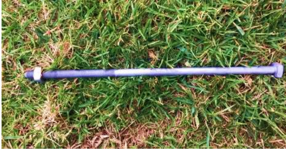
Figura 55. Tornillo de máquina de 15,87 mm (5/8"X18")
