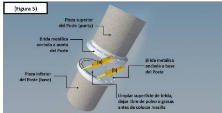
Figura 128. Aplicación de masilla epóxica en flange
