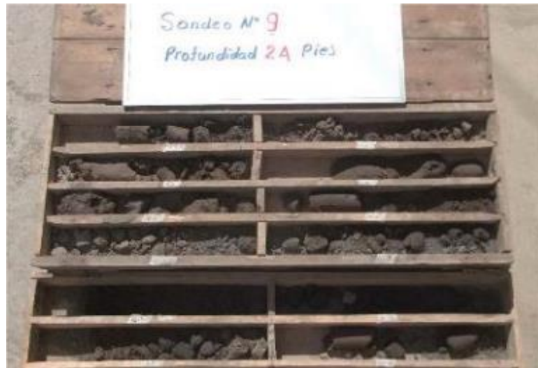
Figura 17. Muestras para pruebas de laboratorio de prueba de SPT
