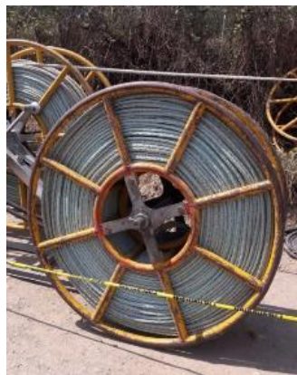
Figura 136. Bobina de guía para tendido de conductores
