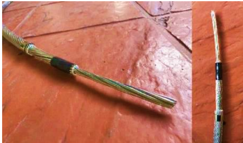
Figura 23. Cable de aleación sin forro 740,8 AWG AAAC ( flint )
