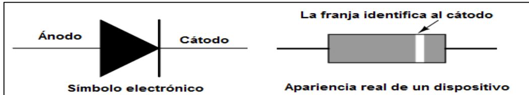
Figura 5. Representación de un diodo ideal
