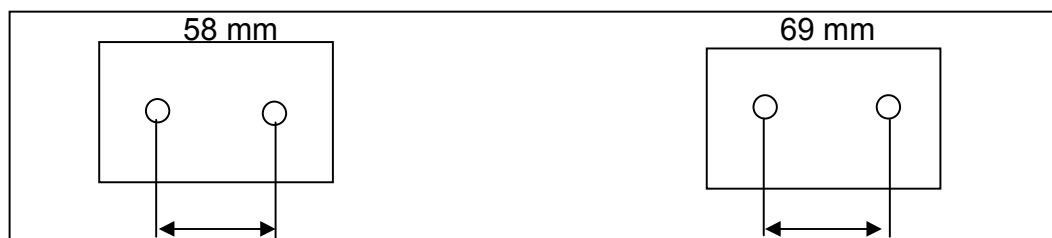
Figura 18 : Esquema de los puntos de anclaje en el cuerpo de la máquina
