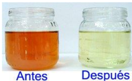
Figura 9. Aceite dieléctrico de un transformador de potencia después de hacerle mantenimiento de filtrado y secado
