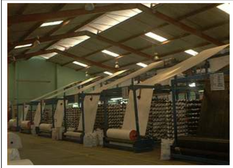
Figura 9. Línea de telares circulares
