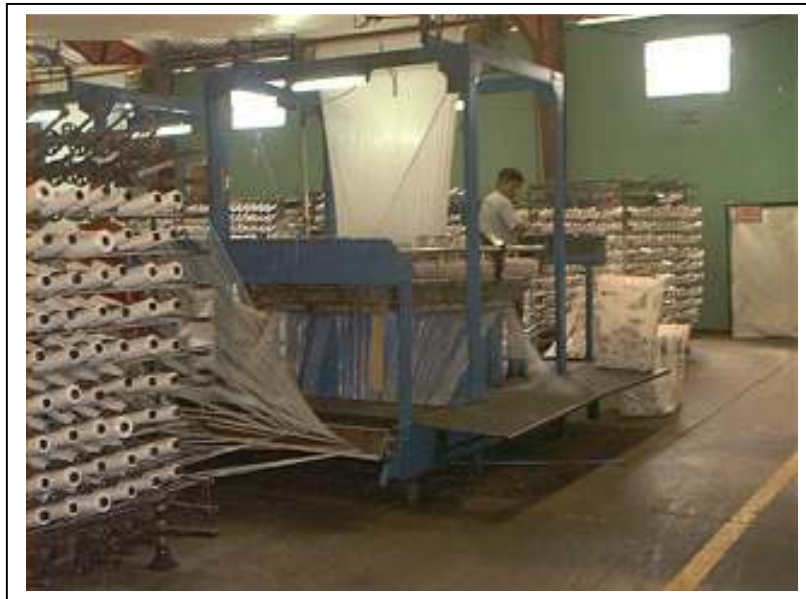
Figura 7. Telar de 6 lanzaderas
