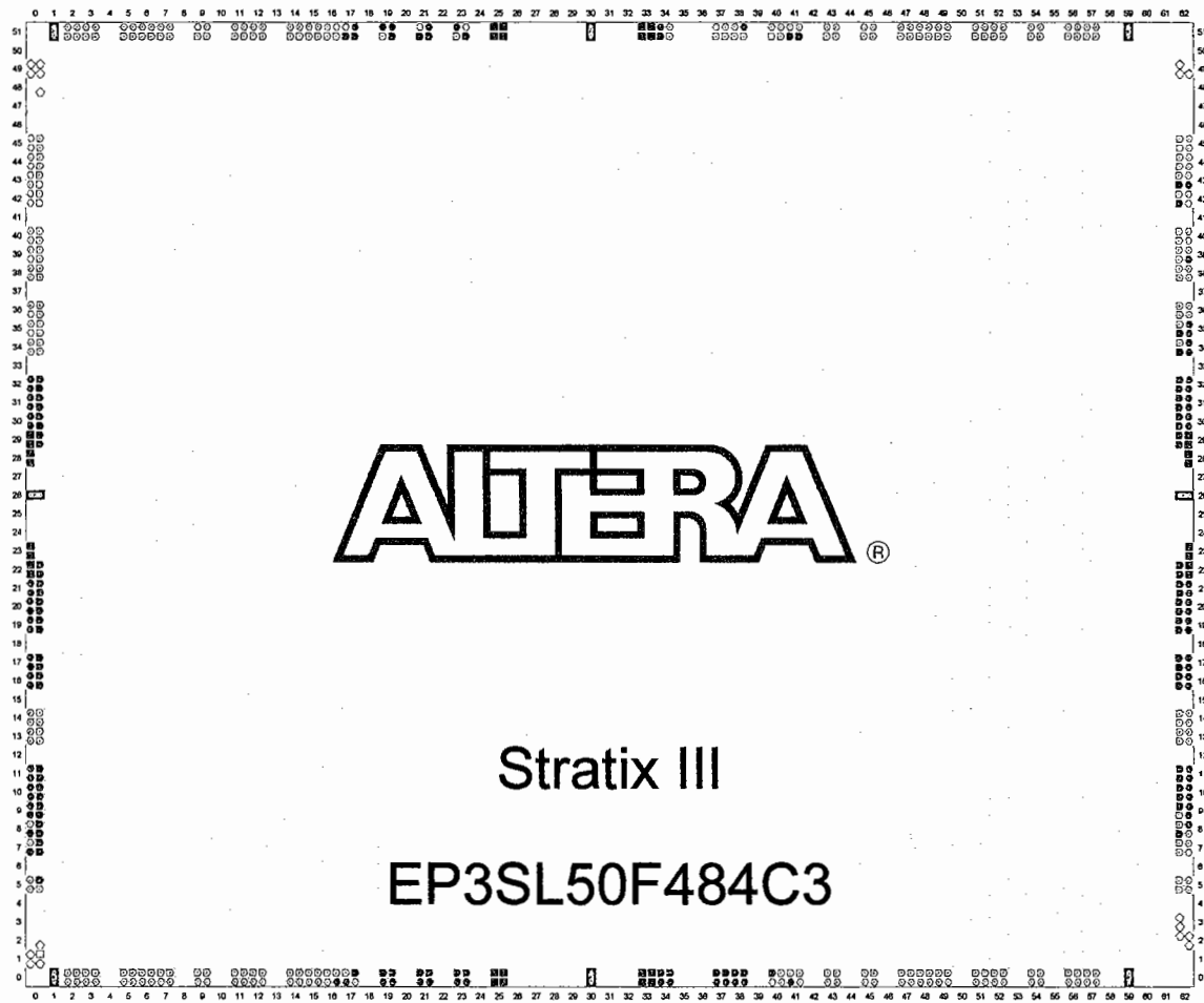
Figura 4. 44 Distribución de pines en el chip
