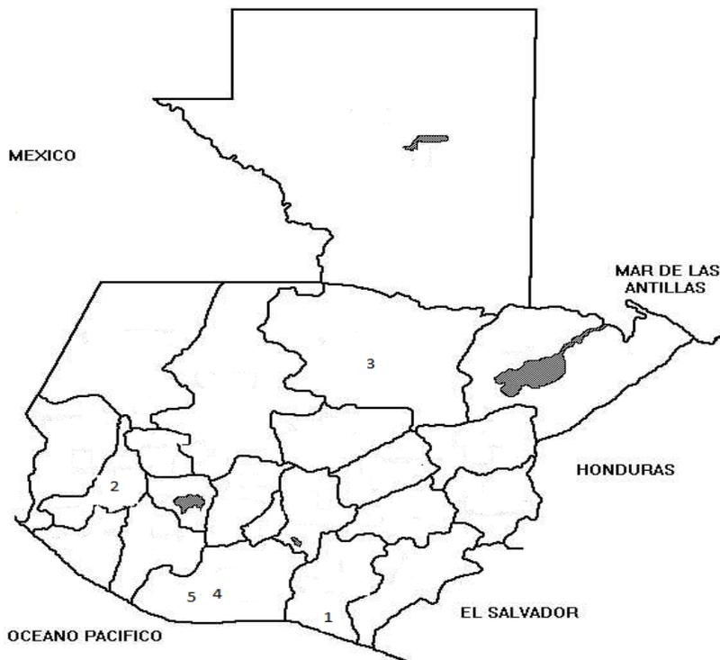
1. Hidroeléctrica Los Esclavos, 2. Hidroeléctrica Santa María, 3. Hidroeléctrica de Chixoy, 4. Hidroeléctrica de Aguacapa, 5. Hidroeléctrica de Jurún Marinalá.
