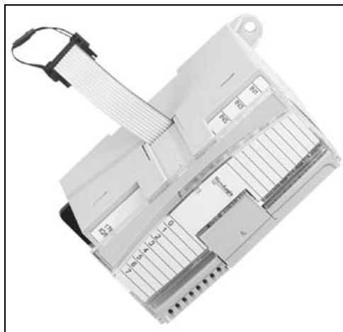
Figura 39. Módulo auxiliar de E/S analógicas Cat. 1762-IF20F2
