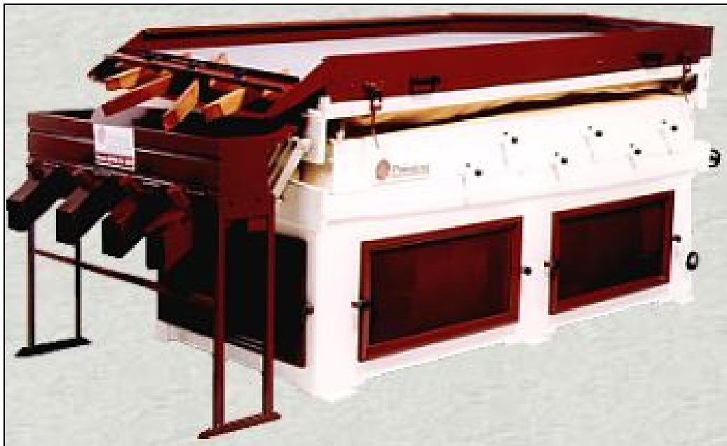
Figura 24. Máquina clasificadora densimétrica
