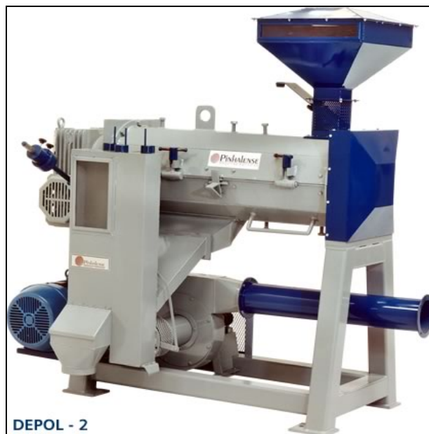
Figura 21. Máquina trilladora – pulidora
