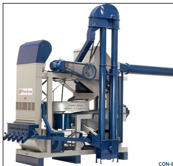
Figura 20. Máquina trilladora conjugada
