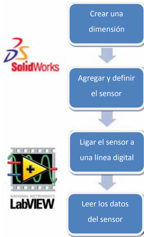
Figura 95. Esquema para la creación de un sensor virtual
