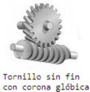
Figura 21. Tornillo sin fin y corona
