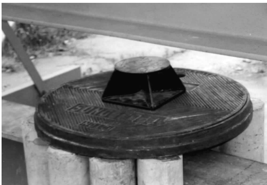
Figura 19. Disco de acero utilizado para transmitir la carga
