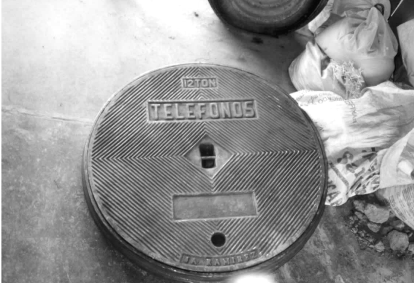
Figura 15. Tapadera de hierro fundido a ser ensayada
