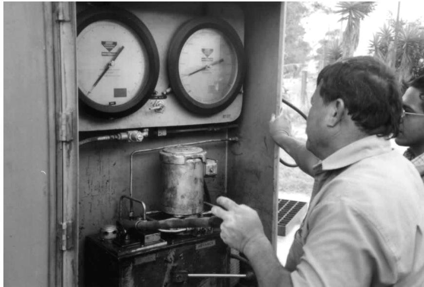
Figura 20. Aplicación de la carga
