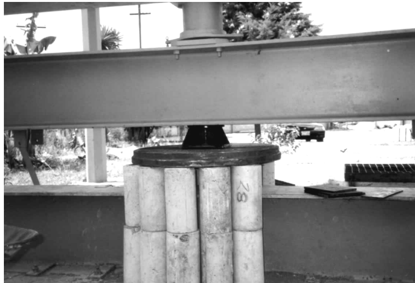
Figura 17. Colocación de la tapadera para el ensayo
