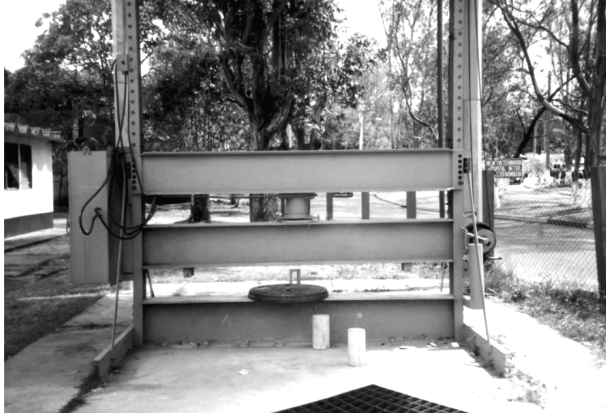
Figura 16. Prensa hidráulica para el ensayo
