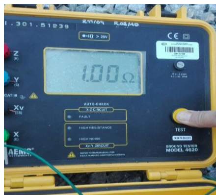
Figura 51. Medición de la resistividad del terreno
