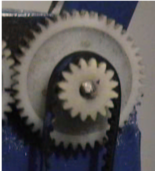
Figura 37. Ejemplo de engranajes y fajas utilizadas en las partes mecánicas del robot
