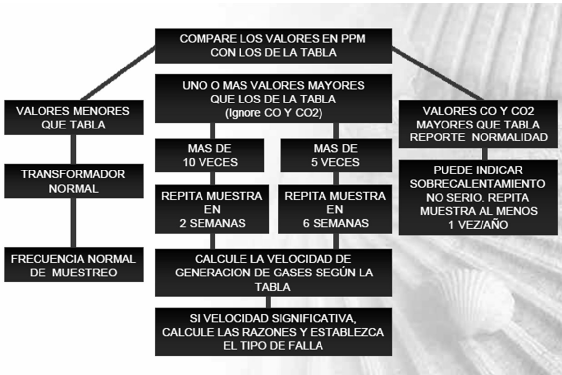
Figura 6. Diagrama de frecuencia de muestreo, válido para Dörnenburg y Rogers
