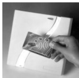
Figura 9. Lector de tarjetas inteligentes sin contacto
