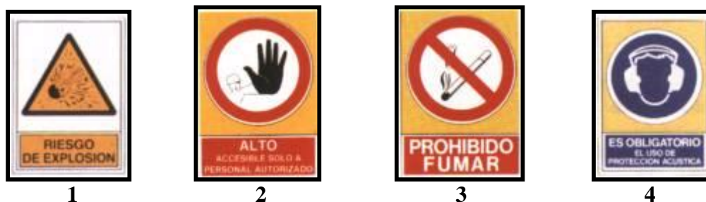
Figura 52. Señalización para cuarto de compresores
