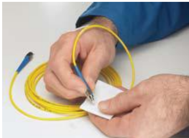
Figura 39. Limpieza de conector de FO
