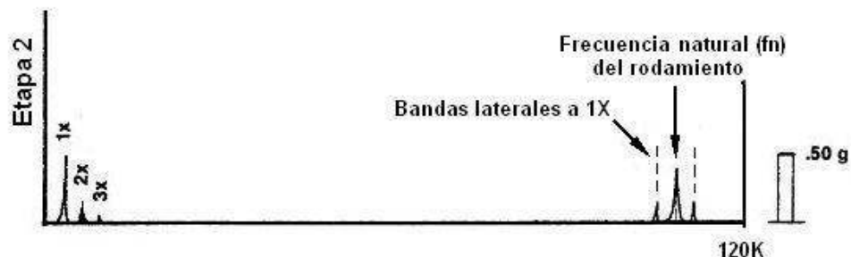
Figura 46. Etapa 2 de falla en los rodamientos.
