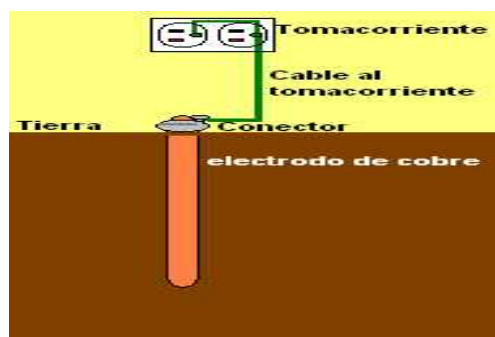
Figura 20. Conexión a tierra del monitor de signos vitales
