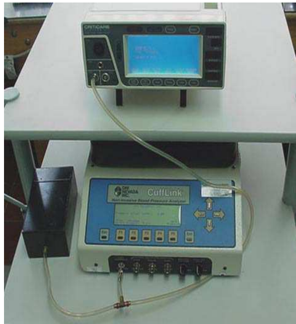
Figura 24. Verificación de NIBP o niveles de presión arterial
