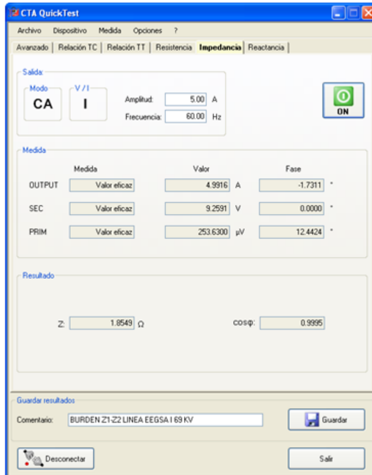
Figura 98. Prueba de burden con equipo CT-Analyzer
