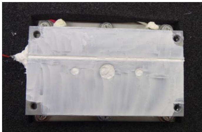
Figura 39. Aplicación de pasta térmica a celular de peltier
