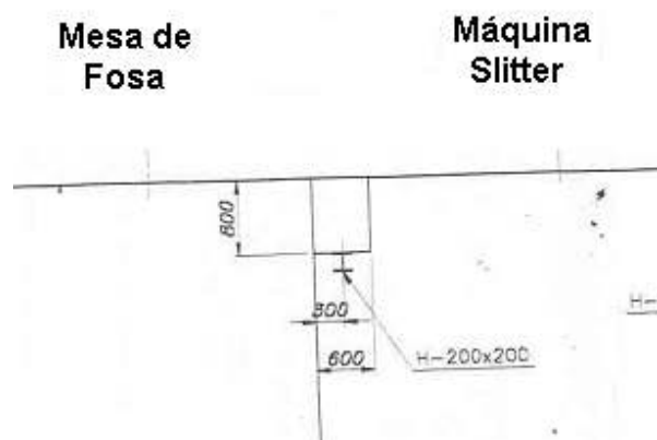
Figura 55: Anclaje de maquina Slitter.
